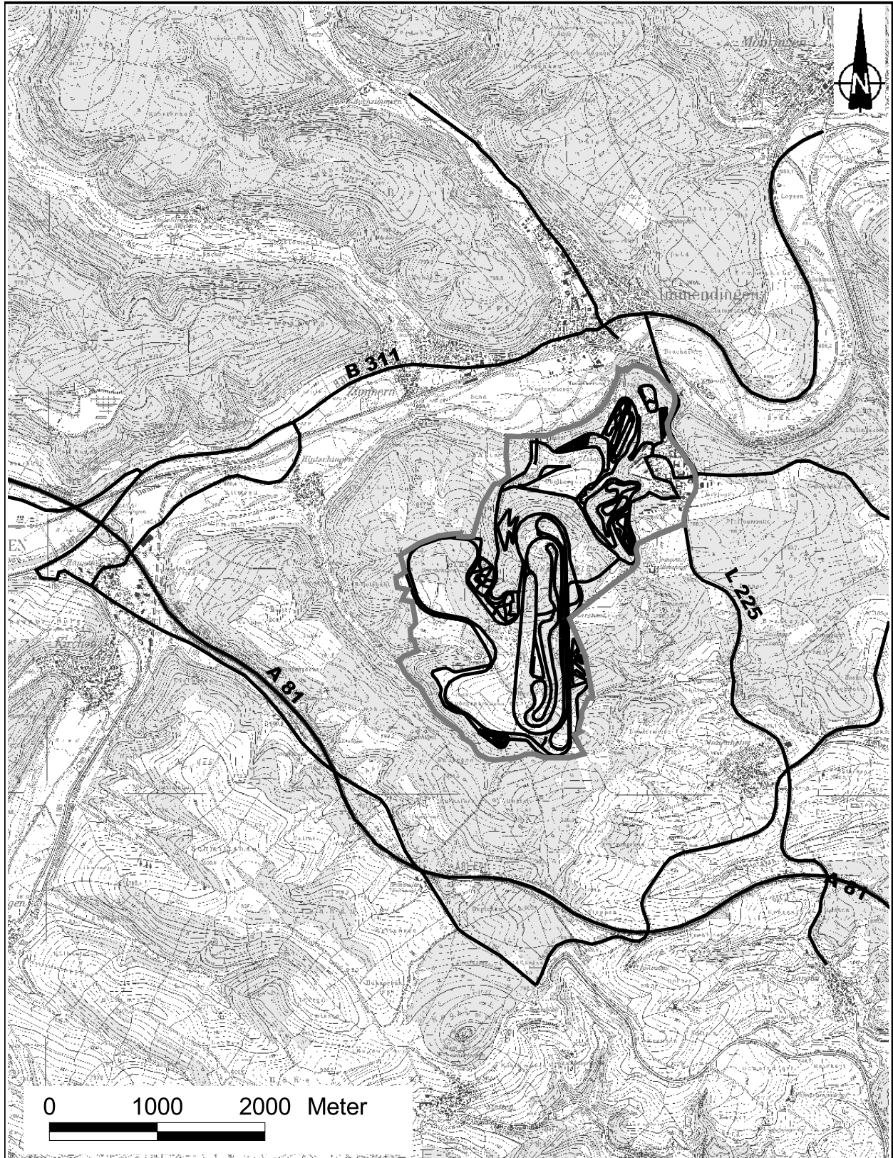
Abb. 4.1: Lageplan des Untersuchungsgebietes. Das bestehende Straßennetz ist schwarz eingezeichnet. Das Gelände des geplanten Prüf- und Technologiezentrums ist dunkelgrau umrandet und zeigt den Entwurf einer möglichen Streckenführung (schwarze Linien)
